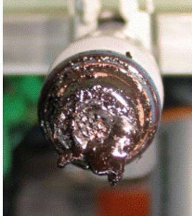
**Bild 18:** Kein Einspritzventilreinigungseffekt mit getesteten PEA basierten Additiven
